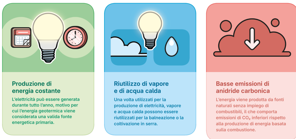
Figura 4.2: principali vantaggi nell'utilizzo della risorsa geotermica: generazione costante di elettricità, possibilità di riutilizzo della risorsa e bassa emissione di CO 2 .
